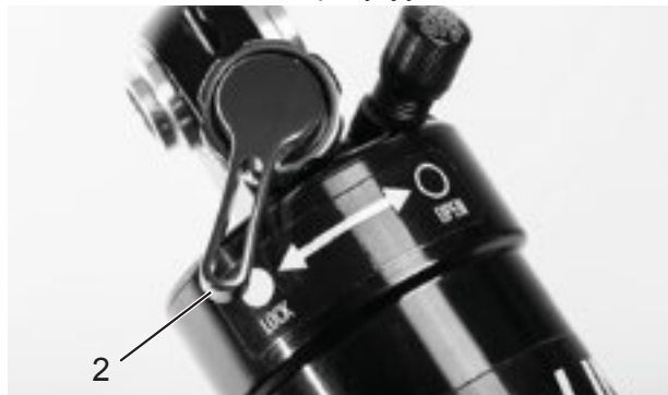
Rysunek 67: Nastawnik dobicia Suntour w pozycji zamkniętej (2)
