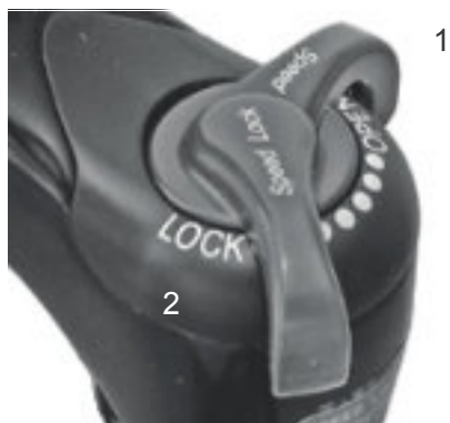
Rysunek 65: Nastawnik dobicia Suntour z pozycjami OPEN (1) i LOCK (2)
