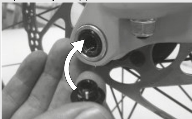
Rysunek 22: Sposób wsuwania dźwigni zacisku szybkocmocującego w oś
