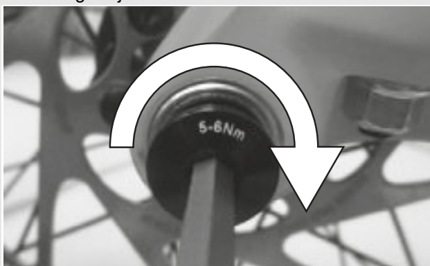
Rysunek 23: Sposób dokręcania śruby zabezpieczającej
