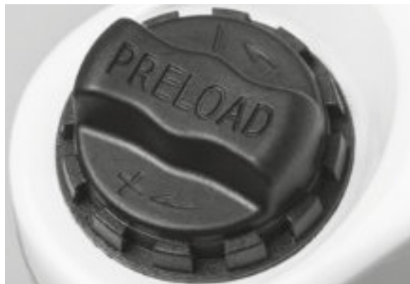
Rysunek 53: Pokrętko regulacyjne ujemnego skoku sprężyny, usytuowane na koronie widelca amortyzowanego
