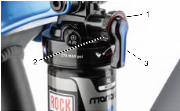
Rysunek 68: Ustawianie twardości tłumika odbicia za pomocą pokrętła regulacyjnego (1)
