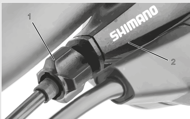
Rysunek 75: Nakrętka regulacyjna (1) jednoczętnego mechanizmu zmiany przerzutek z obudową dźwigni zmiany biegów (2), przykład
