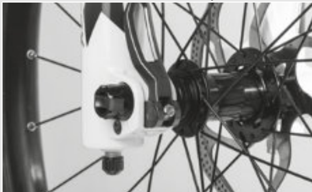
Rysunek 73: Ustawianie siły mocowania zacisku szybko mocującego
