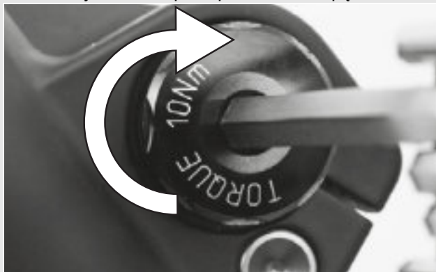
Rysunek 24: Sposób dokręcania włożonej osi
