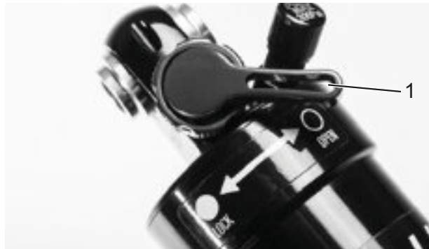
Rysunek 66: Nastawnik dobicia Suntour w pozycji otwartej (1)
